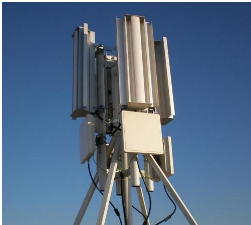
Рисунок 4.1 - Базовая станция Sequans SQN2010 Технические характеристики БС Sequans SQN2010 указаны в таблице 4.3
